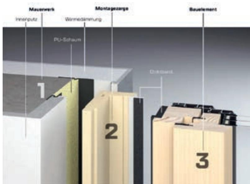
**Schematischer Aufbau einer Montagezargen-Konstruktion. Wenn die Zarge montiert ist, können alle weiteren für den Baufortschritt erforderlichen Arbeiten erfolgen. Das eigentliche Fenster lässt sich später einfach in den passgenauen Rahmen einsetzen.**
